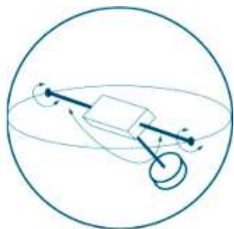
شکل (۱): ساختار کروی ربات کروی پاندولی
