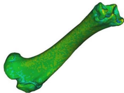
شکل ۵ مدل ناهمگن استخوان با تخصیص چهل ناحیه مجزا برای چگالی و مدول الاستیک
