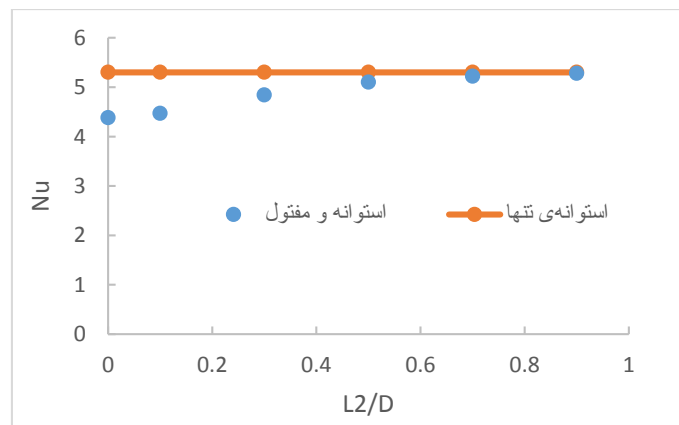
شکل (۱۱): تغییرات عدد نوسلت استوانه تحت تأثیر مفتول کنترل‌گر با قطر 0.3D و در فاصله افقی 3D برحسب فاصله عمودی آن از محور افقی در Re = 100
