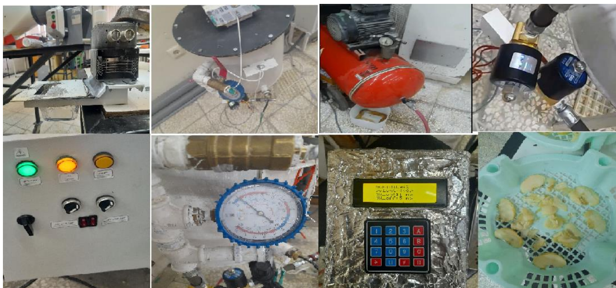
شکل ۲- این تصاویر اجزای واقعی به کار رفته در خشک کن مایکروویو-خلأ را نشان می دهند که شامل تابلو برق و کلیدهای کنترلی، کمپرسور و اجکتور سیستم خلأ، شیر برقی، گیج فشار، واحد ثبت وزن و سبد حاوی نمونه ها داخل محفظه است. این اجزا به صورت یکپارچه برای پایش و کنترل دما، فشار و کاهش وزن نمونه ها در طول فرآیند خشک شدن به کار گرفته شده اند.
