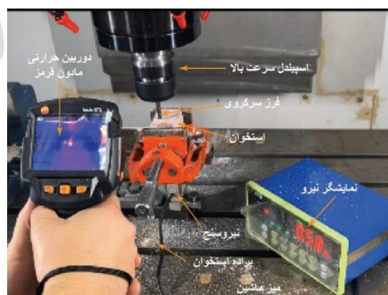
شکل ۴ طبقه انجام آزمایش در فرایند فرزکاری استخوان
