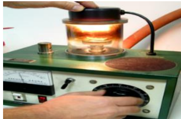
شکل ۵ پوشش دهی نمونه‌ها با طلا
