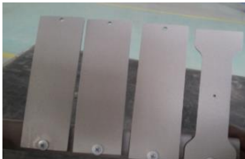
شکل ۳ نمونه های آماده شده جهت فرایند پوشش دهی
