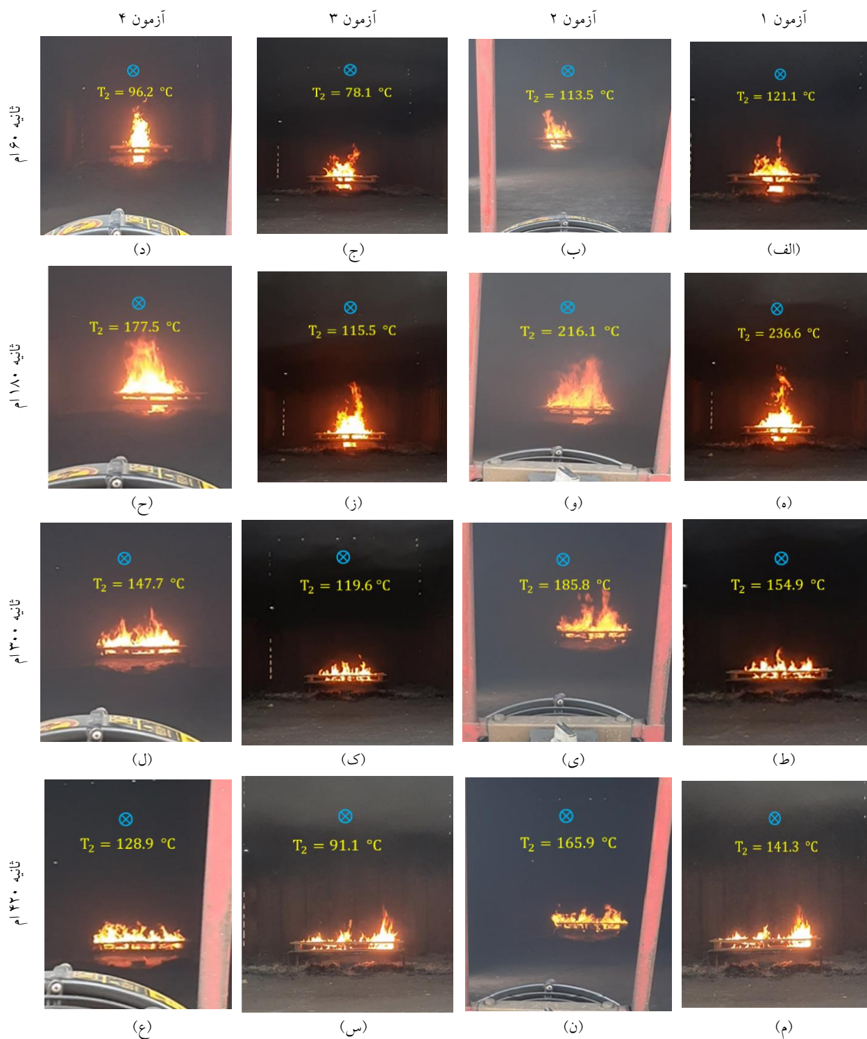
شکل ۱۱ مقایسه تغییرات ظاهر شعله: (الف) تایمه ۱۲۰ آزمایش ۱، (ب) تایمه ۱۲۰ آزمایش ۲، (ج) تایمه ۱۲۰ آزمایش ۳، (د) تایمه ۱۲۰ آزمایش ۴، (ه) تایمه ۱۸۰ آزمایش ۱، (و) تایمه ۱۸۰ آزمایش ۲، (ز) تایمه ۱۸۰ آزمایش ۳، (ح) تایمه ۱۸۰ آزمایش ۴، (ط) تایمه ۳۰۰ آزمایش ۱، (ی) تایمه ۳۰۰ آزمایش ۲، (ک) تایمه ۳۰۰ آزمایش ۳، (ل) تایمه ۳۰۰ آزمایش ۴، (م) تایمه ۴۲۰ آزمایش ۱، (ن) تایمه ۴۲۰ آزمایش ۲، (س) تایمه ۴۲۰ آزمایش ۳، (ع) تایمه ۴۲۰ آزمایش ۴
