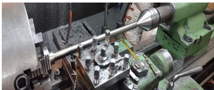
شکل ۱ شفت اینکونل حین تست ماشینکاری
