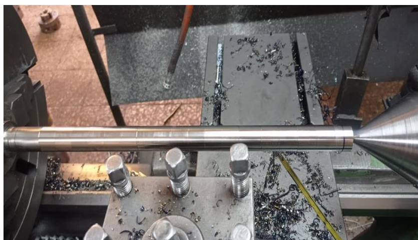
شکل ۳ تقسیم کردن شافت به ۱۸ قسمت مساوی
