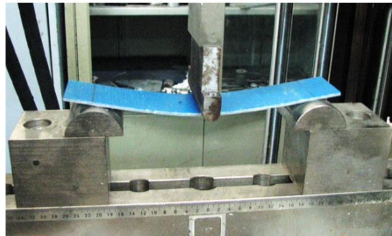
شکل ۲: چیدمان بارگذاری مربوط به آزمایش سه نقطه
