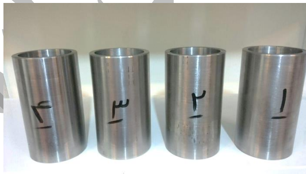
شکل ۶ نمونه‌های آزمایشگاهی تهیه شده از جنس فولاد زنگ‌نزن ۴۲۰
