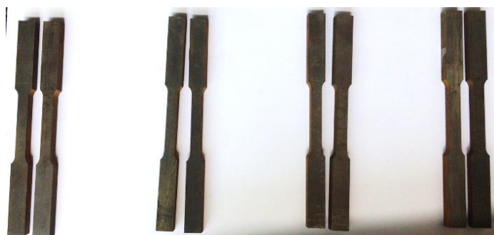
شکل ۷ نمونه‌های استاندارد تست کشش
