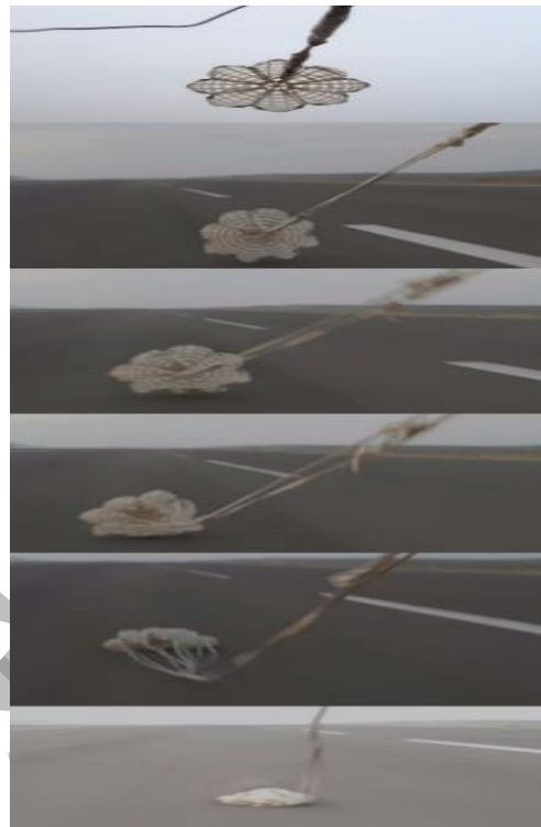
شکل ۱۳. مراحل پریاد شدن چتر ترمزی
