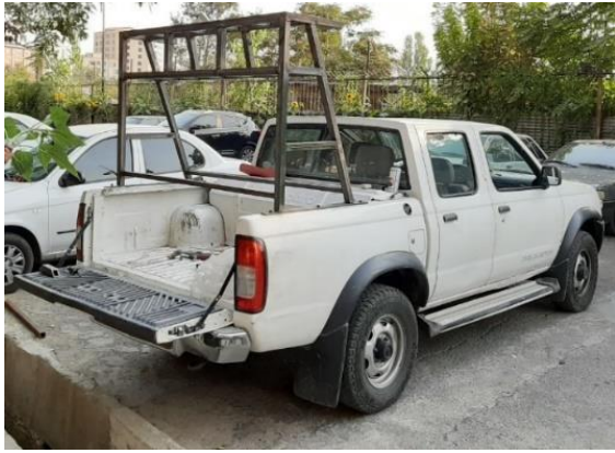
شکل ۱۲. سازه فلزی متصل بر روی خودرو پیکاپ
