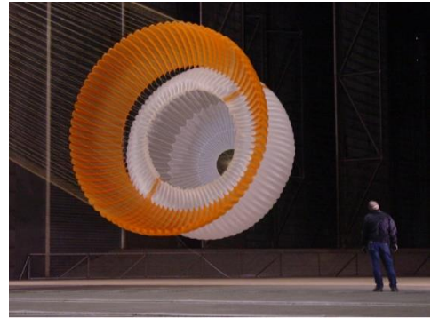
شکل ۳. آزمون تونل باد چتر برای فرود در مریخ [۲۸].
