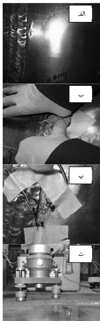
شکل ۳ مراحل آماده سازی آزمون کرنش سنجی سوراخ الف) سطح تمیز شده خارجی لوله پس از صیقل کاری، ب) نحوه‌ی نصب کرنش‌سنج‌ها روی سطح خارجی لوله، پ) پس از قرار دادن کرنش‌سنج، ت) دستگاه فرز قبل از شروع مراحل سوراخکاری
