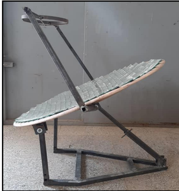
شکل ۶- تصویر واقعی و نهایی دستگاه اجاق خورشیدی
