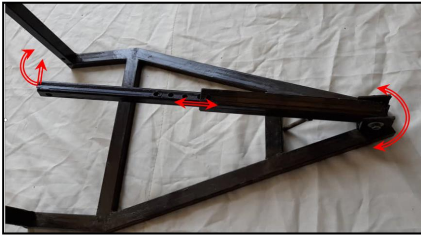
شکل ۴- پایه نگهدارنده و بازوی متحرک جهت تنظیم زاویه در سه بعد
